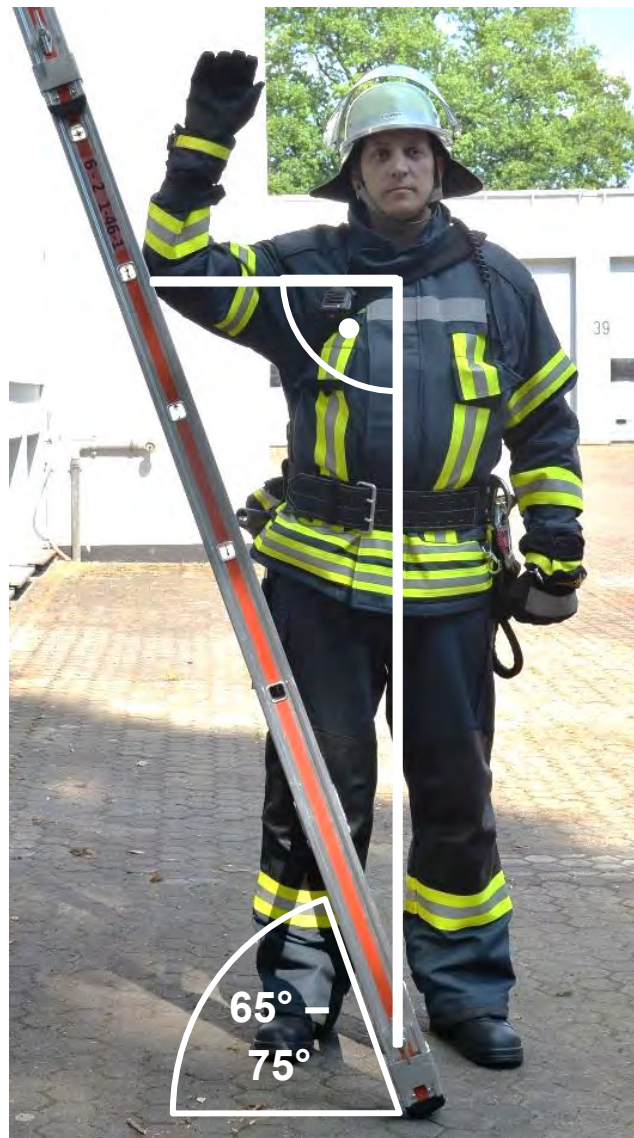
Abbildung 2: Überprüfen des Anstellwinkels
