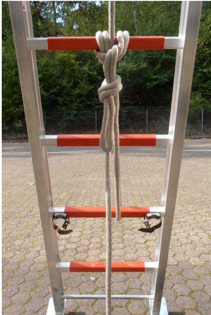
Abbildung 24: Sichern des Zugseils mit Mastwurf und Spierenstich
