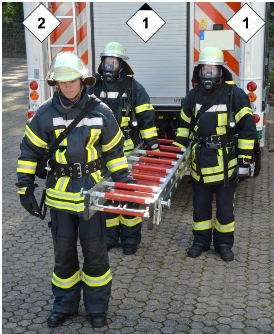
Abbildung 31: Trageweise der Multifunktionsleiter
